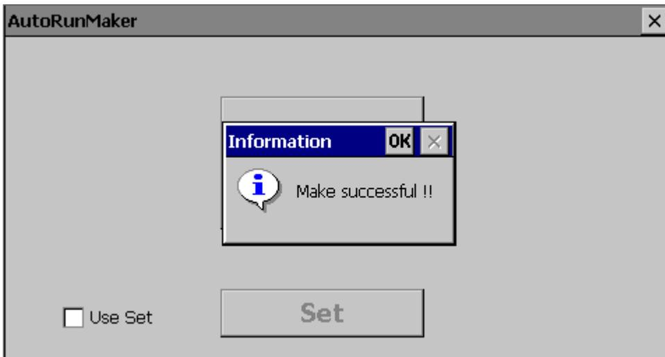
Dieses Fenster mit OK bestätigen, SD Card entfernen. Mit der Schaltfläche **Suspend** die Änderungen speichern. Nach drücken dieser Taste, wird der Bildschirm schwarz und das Panel muss neu gestartet werden.
