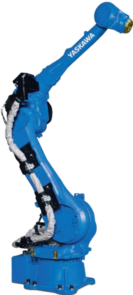
Der MOTOMAN GP50 ist ein flexibler, 6-achsiger Hochgeschwindigkeits-Roboter mit einer Traglast von 50 kg und einem Arbeitsbereich von 2.061 mm. Er ist besonders geeignet für Handling, Maschinenbeschickung, Bearbeitungs- und Klebeapplikationen.
