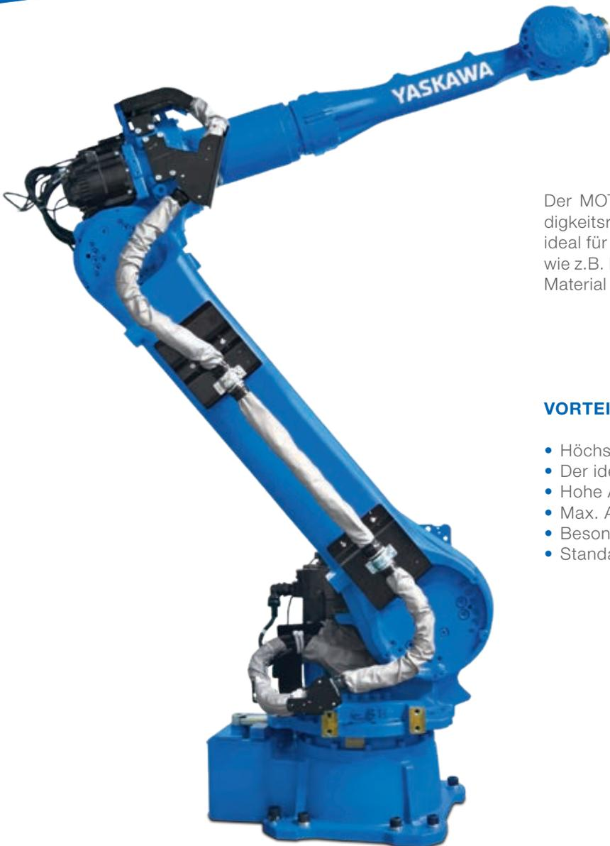
Der MOTOMAN GP35L ist ein dynamischer Hochgeschwindigkeitsroboter. Durch seine extra große Reichweite ist er ideal für große Werkstücke in einer Vielzahl von Applikationen wie z.B. Laserschweißen, Beschichten, Kleben, Schneiden und Material Handling.
