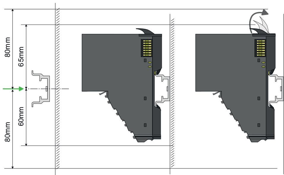
1. ➤ Montieren Sie die Tragschiene! Bitte beachten Sie, dass Sie von der Mitte der Tragschiene nach oben einen Montageabstand von mindestens 80mm und nach unten 80mm einhalten.
