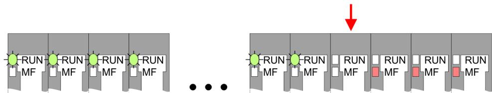
*Verhalten:* Nach dem Einschalten blinken alle RUN-LEDs bis zum fehlerhaften Modul. Bei allen nachfolgenden Modulen leuchtet die MF LED und die RUN-LED ist aus.
