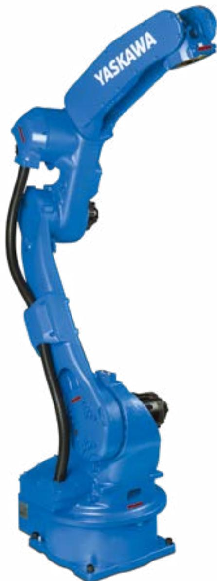
Le MOTOMAN GP25 est un robot industriel 6 axes, rapide et précis, avec une charge utile allant jusqu'à 25 kg. Grâce à sa plage de travail de 1 730 mm et une précision de répétabilité élevée de  $\pm 0,02$  mm, il est parfaitement adapté aux tâches d'assemblage, de manipulation, ou encore à l'alimentation des machines-outils et d'emballage.
