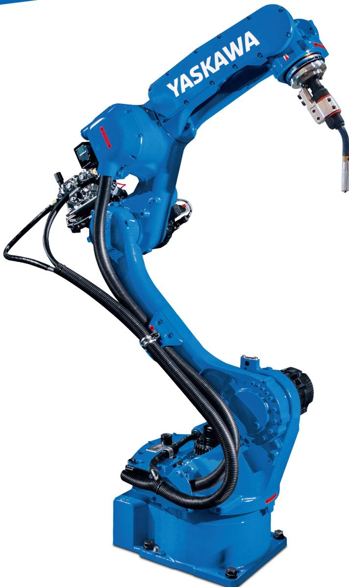
Le MOTOMAN AR1440 est un robot 6 axes à grande vitesse qui offre des performances de répétabilité d'une grande précision pour obtenir des résultats optimaux dans des conditions extrêmement difficiles et surtout pour les exigences élevées des applications de soudage à l'arc.
